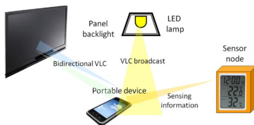
Gambar 1. Aplikasi VLC Pada Indoor Untuk Komunikasi Sekaligus Sharing Informasi [2]
